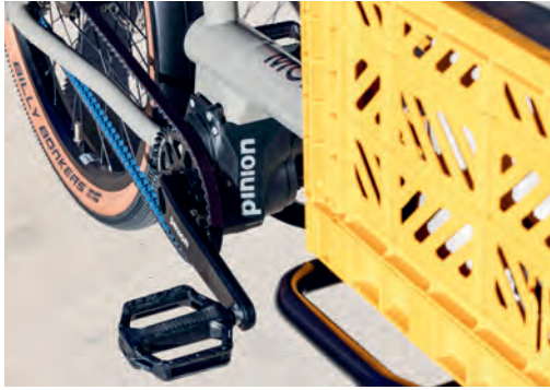
Ein integriertes Getriebe und ein Zahnriemen sorgen für Langlebigkeit und Wartungsarmut. Foto: Jonas Weibel
